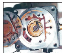
Heizölbrennerpumpe im Betrieb mit Standard-Heizöl schwefelarm im gealterten Zustand Sedimentablagerungen
